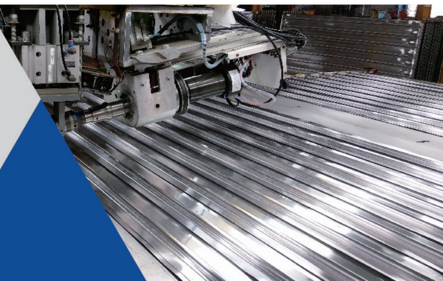
◀綠色製程: 整板金屬超音波焊接 ▼創新結構: F42波浪型熱對流抑制桿
