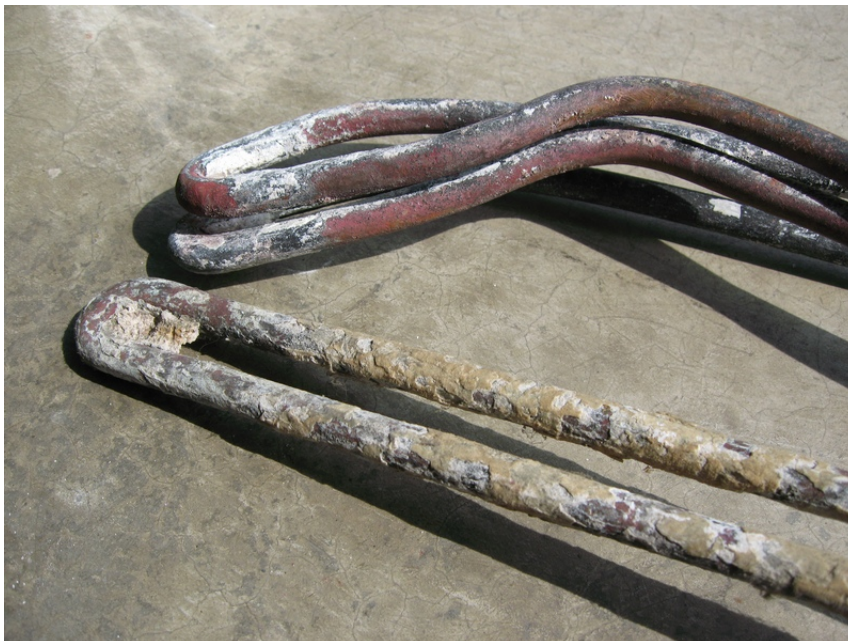
異常原因：水質鈣化包覆 腐蝕破洞
