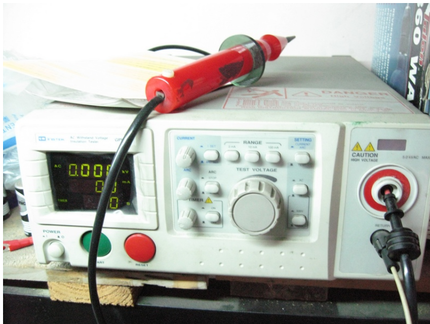
公司品管 產品洩漏電流值檢驗設備
