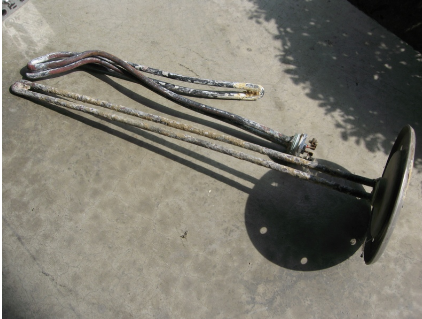
異常原因：水質鈣化包覆 腐蝕破洞
