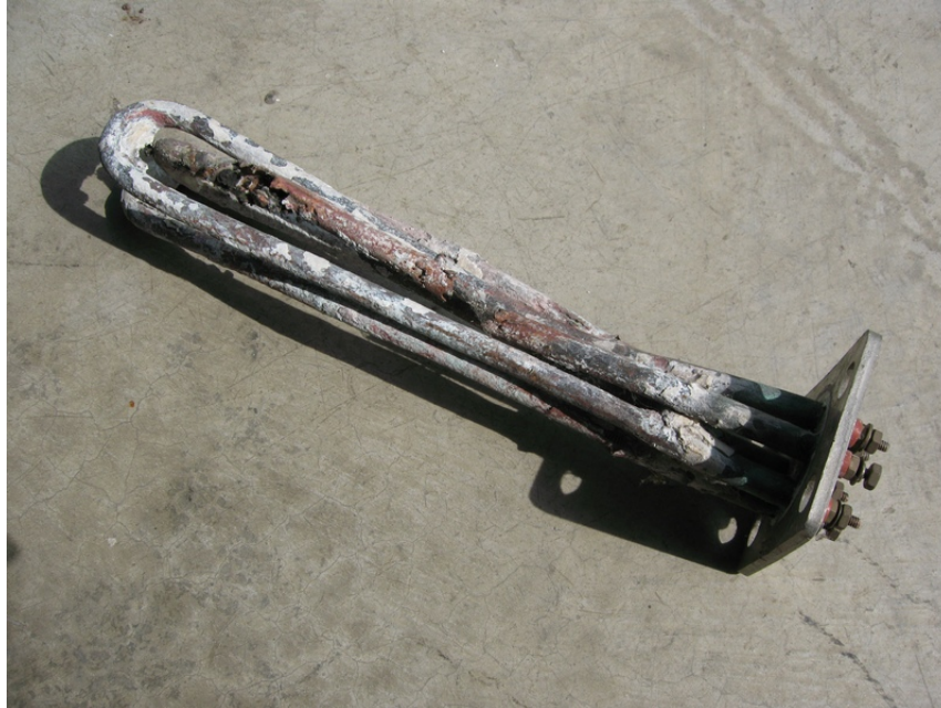
異常原因：水質鈣化包覆 腐蝕破洞
