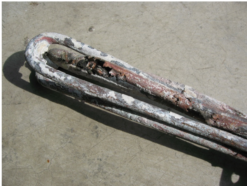
異常原因：水質鈣化包覆 腐蝕破洞
